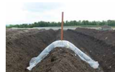
Erfassung der Geruchsfrachten über die gesamte Mietenbreite
