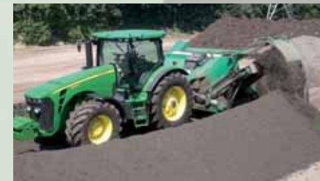
Der TracTurn schneidet Mieten bis 2,3 m Höhe einfach auseinander.
